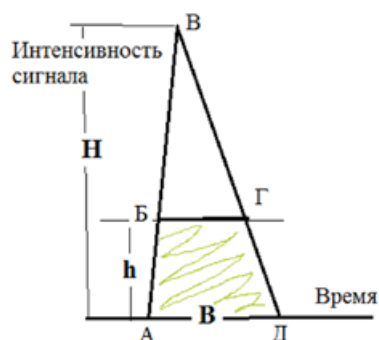
Рис. 2. Схематическая иллюстрация пропорциональности полных площадей хроматографических пиков S(ABD) и их ограниченных по высоте ( h ) составляющих (заштрихованная трапеция ABGD ). Площадь трапеции равна S(1) = hB(1 + k - h/H)/2 , а после увеличения ширины в основании и высоты пика в k раз ( k > 1 ) она увеличивается до S(k) = (1 + k - h/H)/(2 - h/H) .
