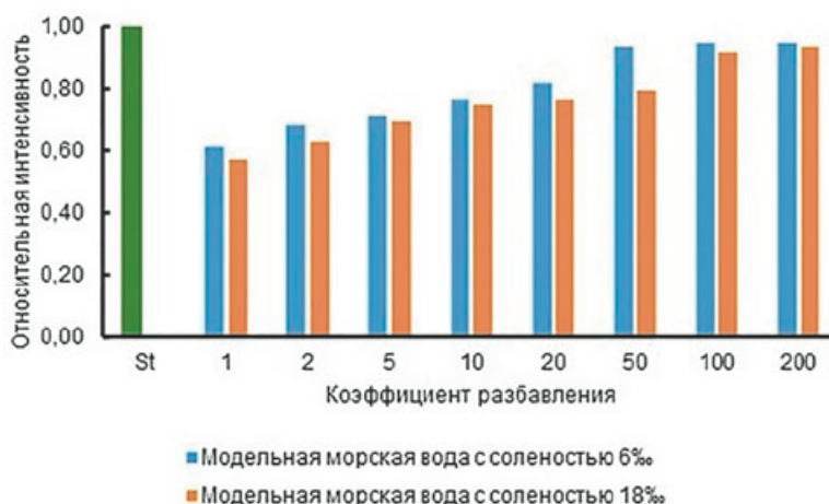
Рис. 5. Влияние разбавления модельных растворов морской воды на AC_{Sn} при ИСП-АЭС-определении олова (концентрация аналита –100 мкг/дм 3 ).
