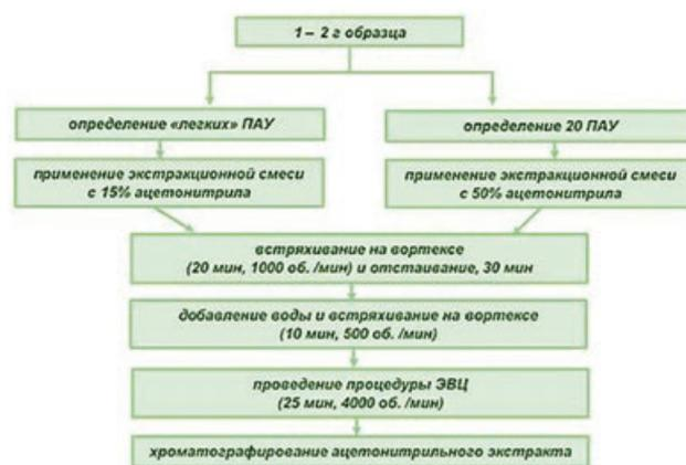
**Рис. 3.** Схемы пробоподготовки почв и донных отложений при ГХ-МС-определении ПАУ с использованием техники ЭВЦ.
