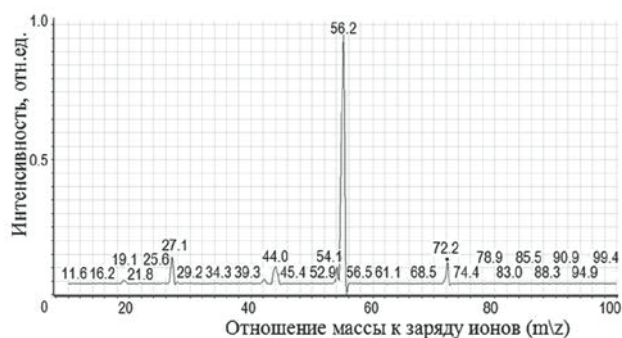
Рис. 4. Масс-спектр акриламида в условиях электроспрей ионизации положительных ионов.
