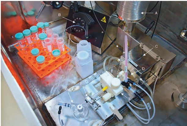
Рис. 3. Внутреннее содержимое защитного химического бокса: А – вытяжка продуктов горения, В – трехканальный перистальтический насос, С – СВЧ резонатор с защитным кожухом, D – плазменная горелка, E – быстросъемный зажим горелки, F – быстросъемный зажим распылительной камеры, G – распылитель и распылительная камера.
