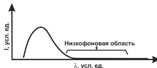
Рис. 3. Схематичное изображение спектра излучения рентгеновской трубки после прохождения через фильтр (интенсивность I и длина волны \lambda приведены в условных единицах)
