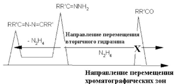
Рис. 5. Схема взаимодействия вторичного гидразина, образующегося в хроматографической колонке из гидразона при образовании азина, с исходным карбонильным соединением и образованием диффузного пика гидразона, характеризующегося меньшими временами удерживания, чем гидразона, содержащегося в реакционной смеси. «X» – область взаимодействия гидразина с карбонильным соединением
