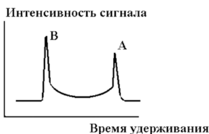
Рис. 2. Схематическое изображение хроматограммы нестабильного соединения А, превращающегося в соединение В в хроматографической колонке в процессе разделения (воспроизведен рисунок из статьи [11]). Для процесса В → А профиль хроматографического сигнала аналогичен
