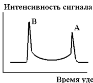
Рис. 4. Схематическое изображение хроматограммы соединения А, нестабильного в условиях анализа и превращающегося в соединение В в хроматографической колонке
