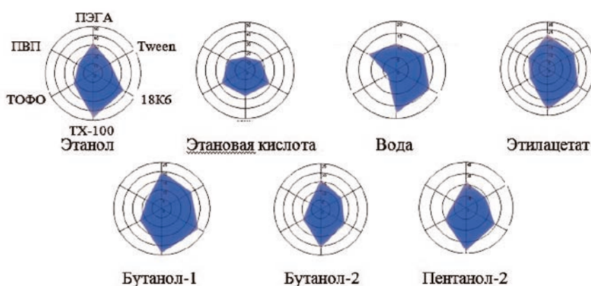
Рис.1. «Визуальные отпечатки» максимальных сигналов сенсоров в равновесной газовой фазе над тест-веществами. По кругу отмечены наименования сенсоров в массиве
