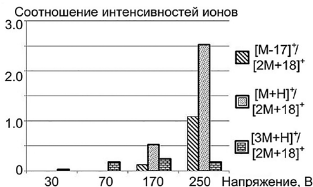
Рис. 7. Зависимость соотношений интенсивностей сигналов различных ионов в масс-спектрах DART водных растворов ОМФ от напряжения на входном капилляре квадрупольного масс-спектрометра (содержание 1 мг/мл, T_{DART} = 250 °С; n = 3 ), воспроизведено с разрешения из [12] © 2012 Elsevier
