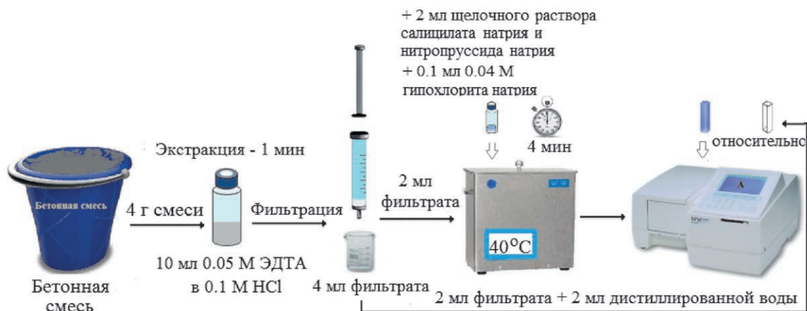
Рис. 6. Схема спектрофотометрического определения ионов аммония в бетонных смесях
