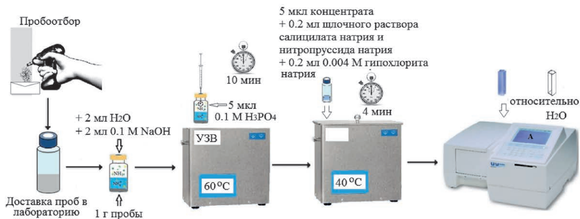
Рис. 3. Схема спектрофотометрического определения ионов аммония в бетонах с использованием парофазной микроэкстракции
