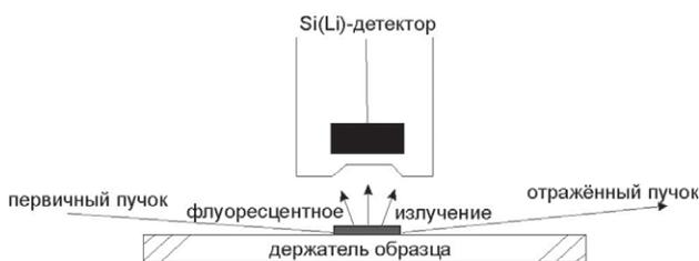
Рис. 2. Принцип действия рентгеновского спектрометра с полным внешним отражением [60]
