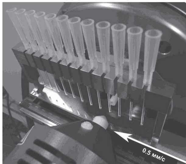
Рис. 1. Автоматизированный анализ 12 жидких образцов методом масс-спектрометрии DART
