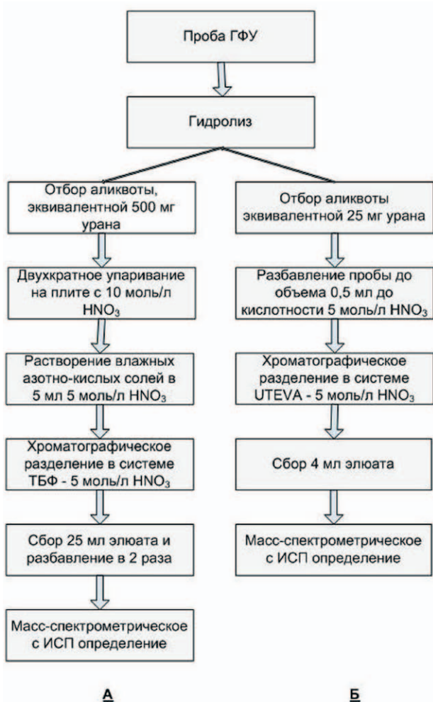
Рис. 5. Блок-схемы методик определения содержания примесей в ГФУ: А - действующей химико-масс-спектрометрической методики [4], Б - разработанной методики с разделением урана и примесей на смоле UTEVA
