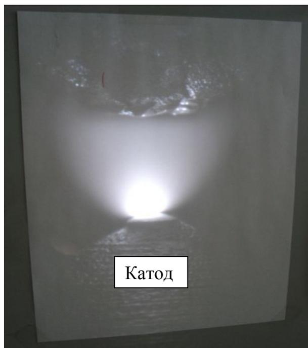
Рис. 3. Внешний вид типичного дугового разряда в ксеноновой лампе сверхвысокого давления с короткой дугой
