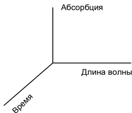
Рис. 18. Способ трехмерной регистрации аналитического сигнала в атомно-абсорбционных приборах высокого разрешения с непрерывным источником спектра (3D-графика)
