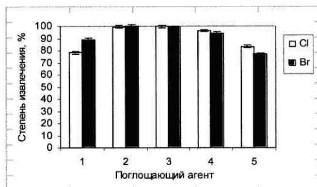
Рис. 1. Степени извлечения хлора и брома в раствор после микроволнового сжигания проб в потоке кислорода в зависимости от поглощающего агента: NaOH (1 – 0,05; 2 – 0,1; 3 – 0,25 и 4 – 0,5 %), 5 – NaHCO_3 + Na_2CO_3
