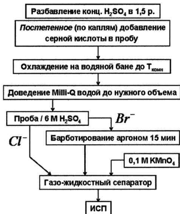
Рис. 4. Схема подготовки проб к анализу после процедуры микроволнового сжигания в потоке кислорода
