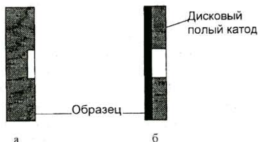
Рис. 5. Создание эффекта полого катода с использованием стандартной лампы тлеющего разряда по Гримму: цилиндрическая выемка в компактном и толстом металлическом образце – а, наложение металлической шайбы на тонкий проводящий образец – б
