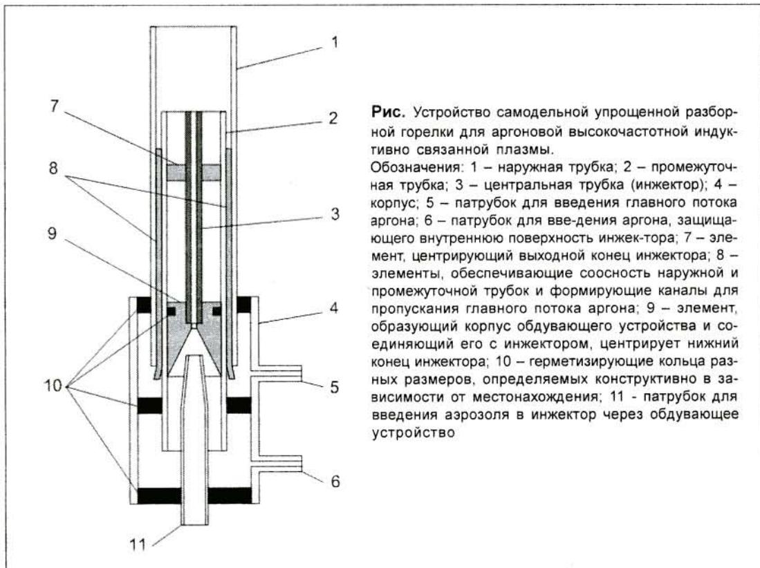
**Рис.** Устройство самодельной упрощенной разборной горелки для аргоновой высокочастотной индуктивно связанный плазмы.
