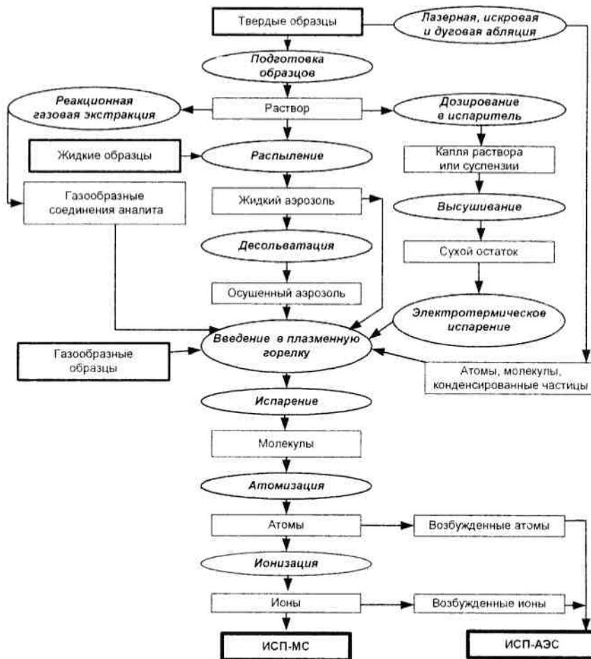
**Рис.** Упрощенная схема введения образцов в методах ИСП-АЭС и ИСП-МС, происходящие при этом процессы, возникающие формы анализов и других компонентов
