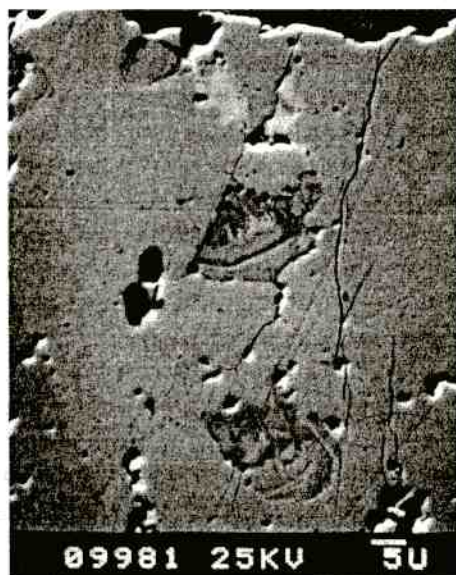
Рис. 1. Включения колумбита-танталита разного состава в касситерите. Изображение в обратно рассеянных электронах. Ускоряющее напряжение - 25 кВ. Размер маркера - 5 мкм. Фотография выполнена А. Ведеполь (ЮАР)
