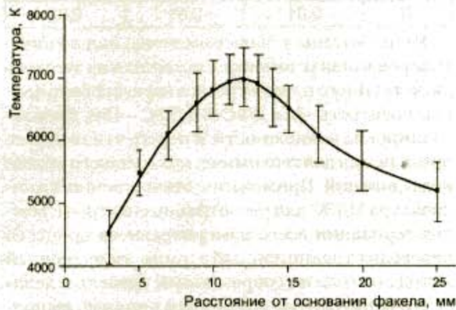
Рис.4. Распределение температуры по высоте факела плазматрона
