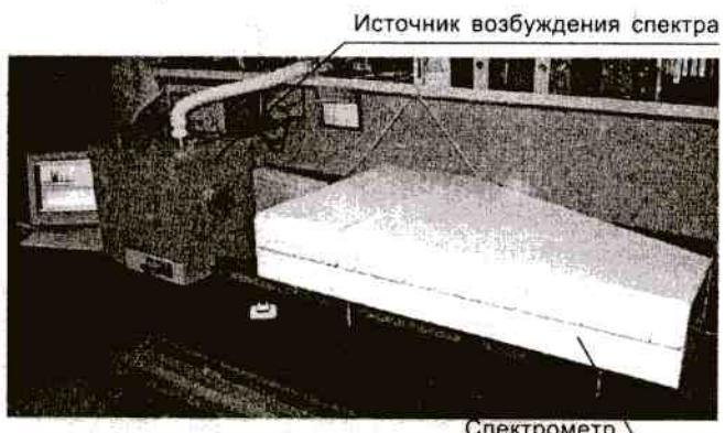
Рис. 7. Внешний вид спектрометра в составе комплекса для АЭС анализа
