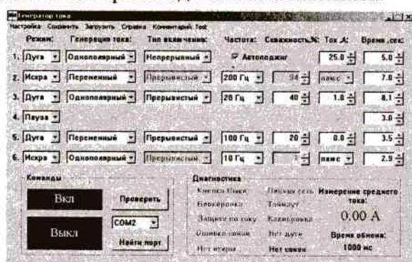
Рис.8. Основное меню программы управления генератором «Шаровая Молния»
