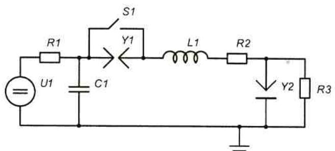
Рис.3. Принципиальная схема генераторов «Высоковольтная искра»
