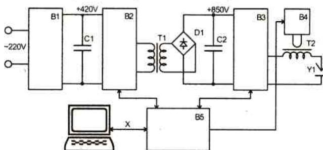
Рис.7. Принципиальная схема генераторов «ШМ250»
