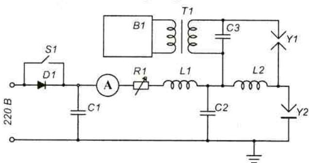
Рис.1. Принципиальная схема генераторов «Дуга постоянного/переменного/непрерывного/пульсирующего тока», «Низковольтная искра»
