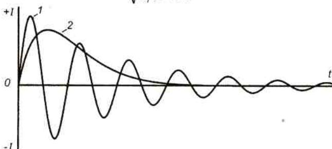
**Рис.4.** Типичный вид искрового разрядного тока
