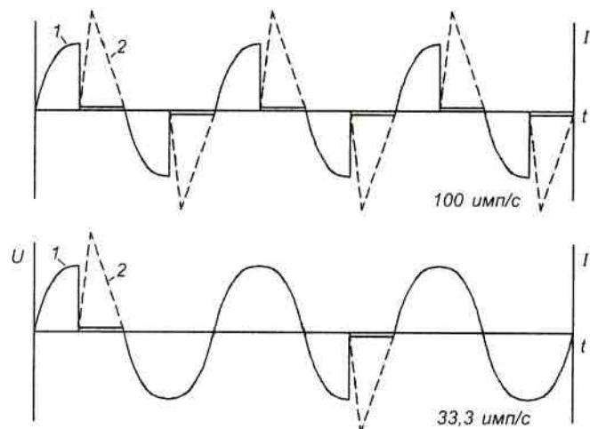
Рис.2. Типичные диаграммы напряжения (1) и силы тока (2) в режиме «Дуга Переменного Тока»
