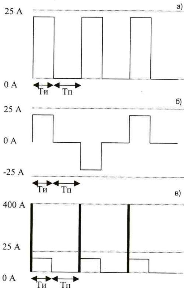
**Рис.1.** Эпюры выходных токов генератора в различных разрядах: а) прерывистый ток, б) переменный ток, в) комбинированный разряд,  $T_{и}$  – длительность импульса тока,  $T_{п}$  – длительность паузы
