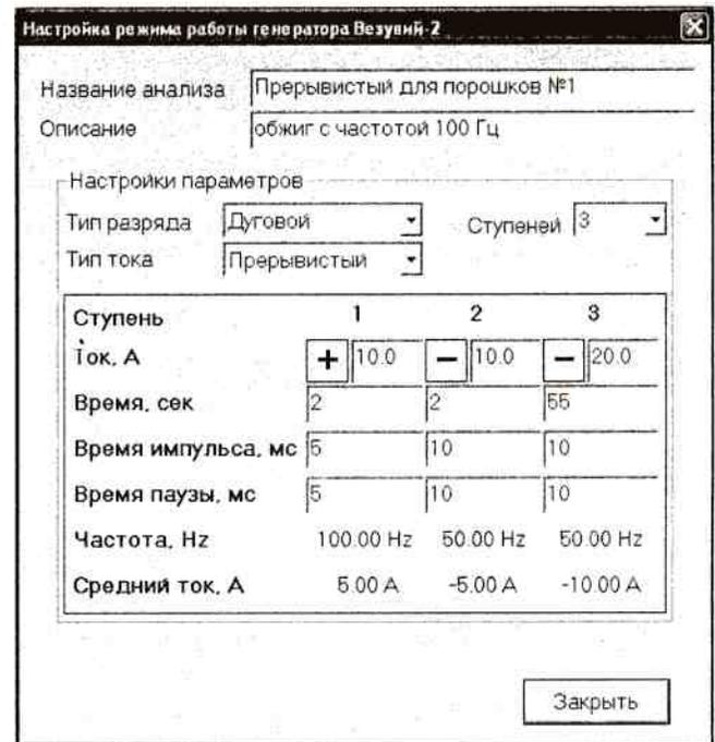
Рис.4. Окно «Настройка режима работы генератора Везувий-2»
