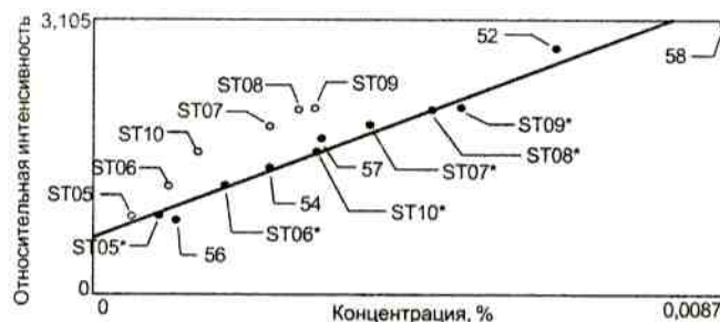
Рис. 1. Градуировочный график для определения кальция на квантометре PDA 5017G.
