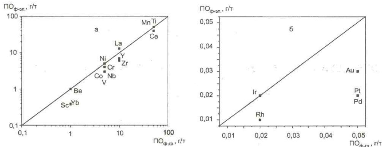
Рис. 2. Сопоставление пределов обнаружения ПО тугоплавких элементов (а), золота и платиноидов (б) в горных породах с фотоэлектронной ПО<sub>ф-эл.</sub> и фотографической ПО<sub>ф-пр.</sub> регистрацией спектров
