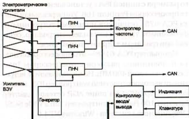
Рис.2. Структура канала регистрации ионного тока МТИ-350Г
