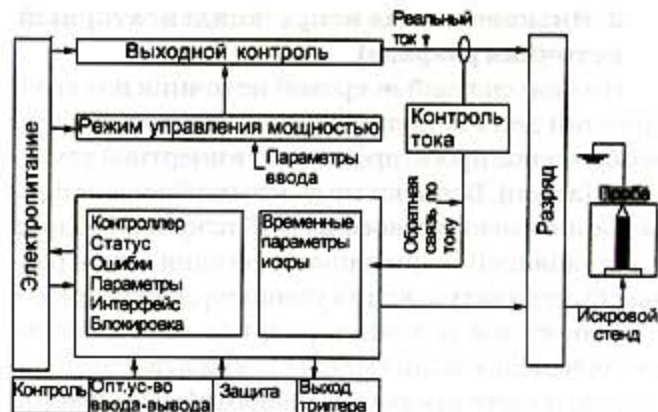
Рис.2. Блок-схема источника возбуждения SOURCE 3000
