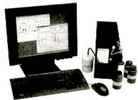
Рис.1. Общий вид прибора LaserNet Fines
