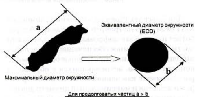
Рис.5. Максимальный и эквивалентный диаметры окружности
