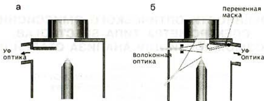
Рис.1. Традиционный искровой стенд с маскированным наблюдением плазмы (а); искровой стенд с функцией переменной маски и мультиоптической системой (б)
