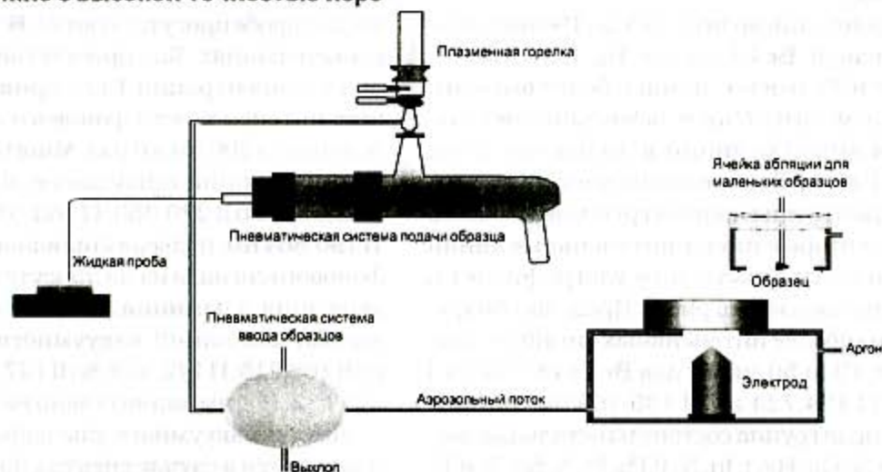
Рис.4. Схематическое изображение системы искровой абляции пробы SPECTRO SASSY
