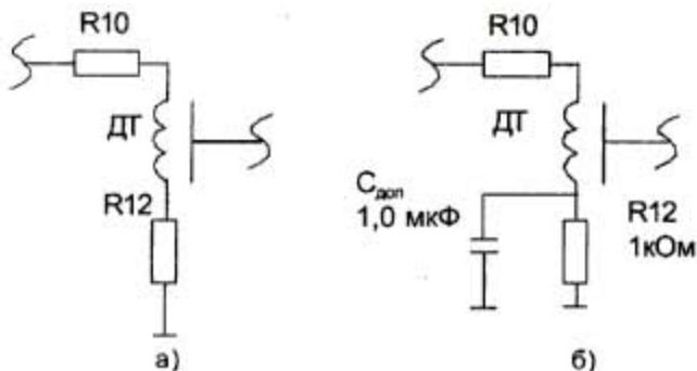
Рис.3. Фрагмент принципиальной электрической схемы микромодуля ДТ: а - заводская схема; б - измененная схема
