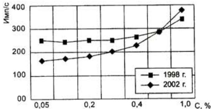
Рис. 1. Зависимость интенсивности линии  $FK_{\alpha}$  от концентрации фтора
