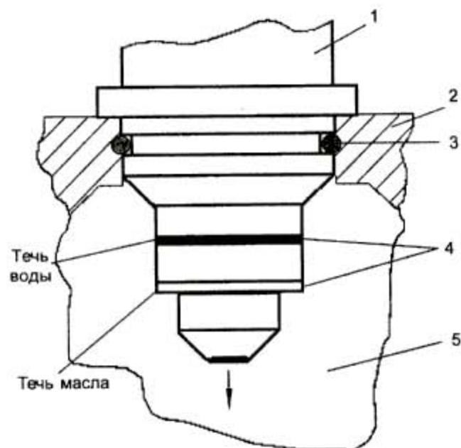
Рис.4. Места соединительных швов корпуса рентгеновской трубы ЗРХВ-2 и их расположение в спектрометре:
