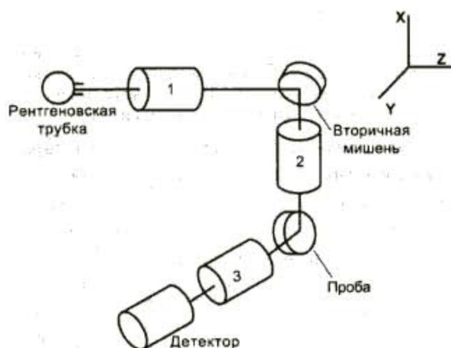
**Рис.1.** Трехосевая рентгенооптическая схема измерений спектрометра СРВ-1-В:
