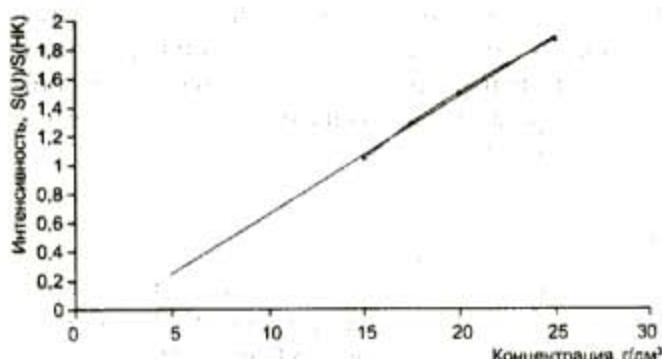
Рис.5. Градуировочный график зависимости интенсивности от концентрации U в растворе для способа стандарта фона, построенный по разбавленным образцам.
