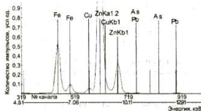
**Рис.2.** Наложение линий  $CuK_{\alpha 1}$  и  $ZnK_{\alpha 1,2}$  в цинковом концентрате
