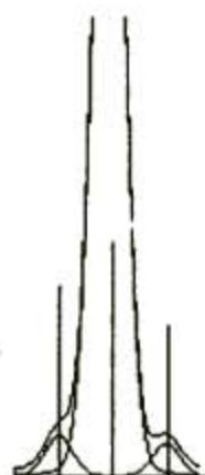
Рис.4. Пример разделения энергетических линий PbL<sub>1</sub> и BiL<sub>1</sub> с помощью метода Гаусс-анализа
