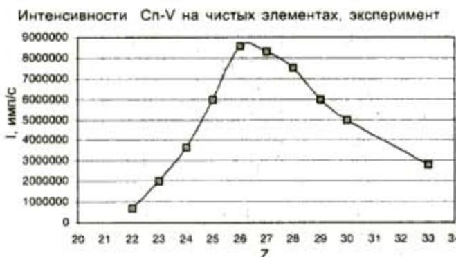
Рис.5. Скорости счета, полученные на вакуумном спектрометре «СПЕКТРОСКАН МАКС-GV» при режимах рентгеновской трубки БХВ-17(Pd) 40 кВ, 4 мА для группы элементов от Ti до As (кристалл-анализатор LiF(200))
