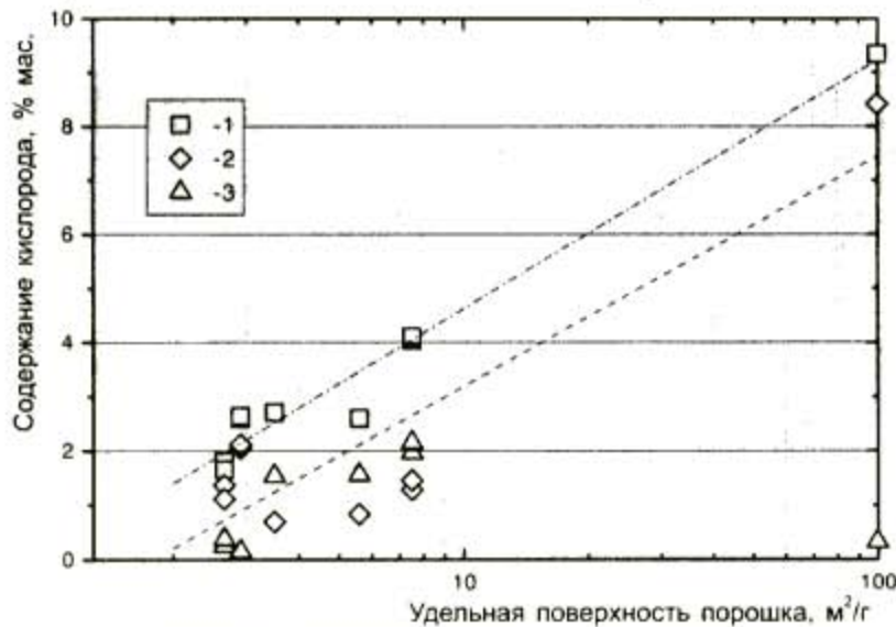
Рис.6. Результаты фракционного анализа порошков никеля различного гранулометрического состава на приборе ТС-436 ЛЕКО. Зависимость 1 – общего содержания кислорода в порошке, 2 – кислорода адсорбированного на поверхности частиц, 3 – находящегося в частицах порошка от величины удельной поверхности порошка м 2 /г
