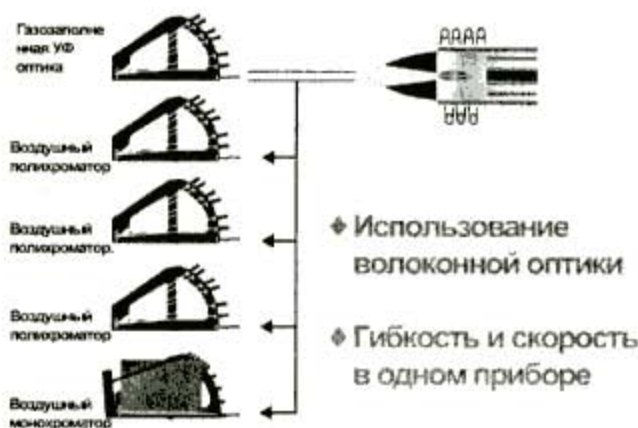
Рис.3. Оптическая схема SPECTROFLAME Modula с аксиальным просмотром плазмы
