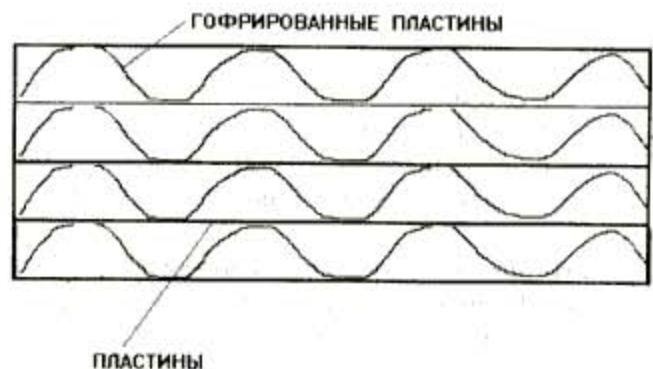
Рис.4.Поперечный разрез эмиттера молекулярного пучка
