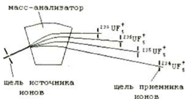
Рис. 1. Принципиальная схема четырехколлекторной системы регистрации ионов
