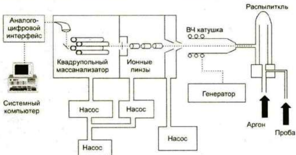
Рис. 1. Принципиальная блок-схема масс-спектрометра ELAN 5000.
